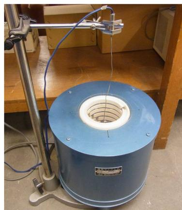
図 2. 電気炉
