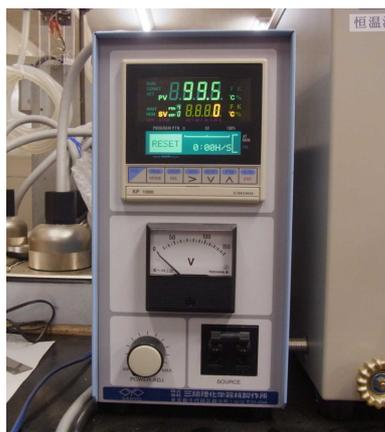
図 1. 精密自動温度調節器
